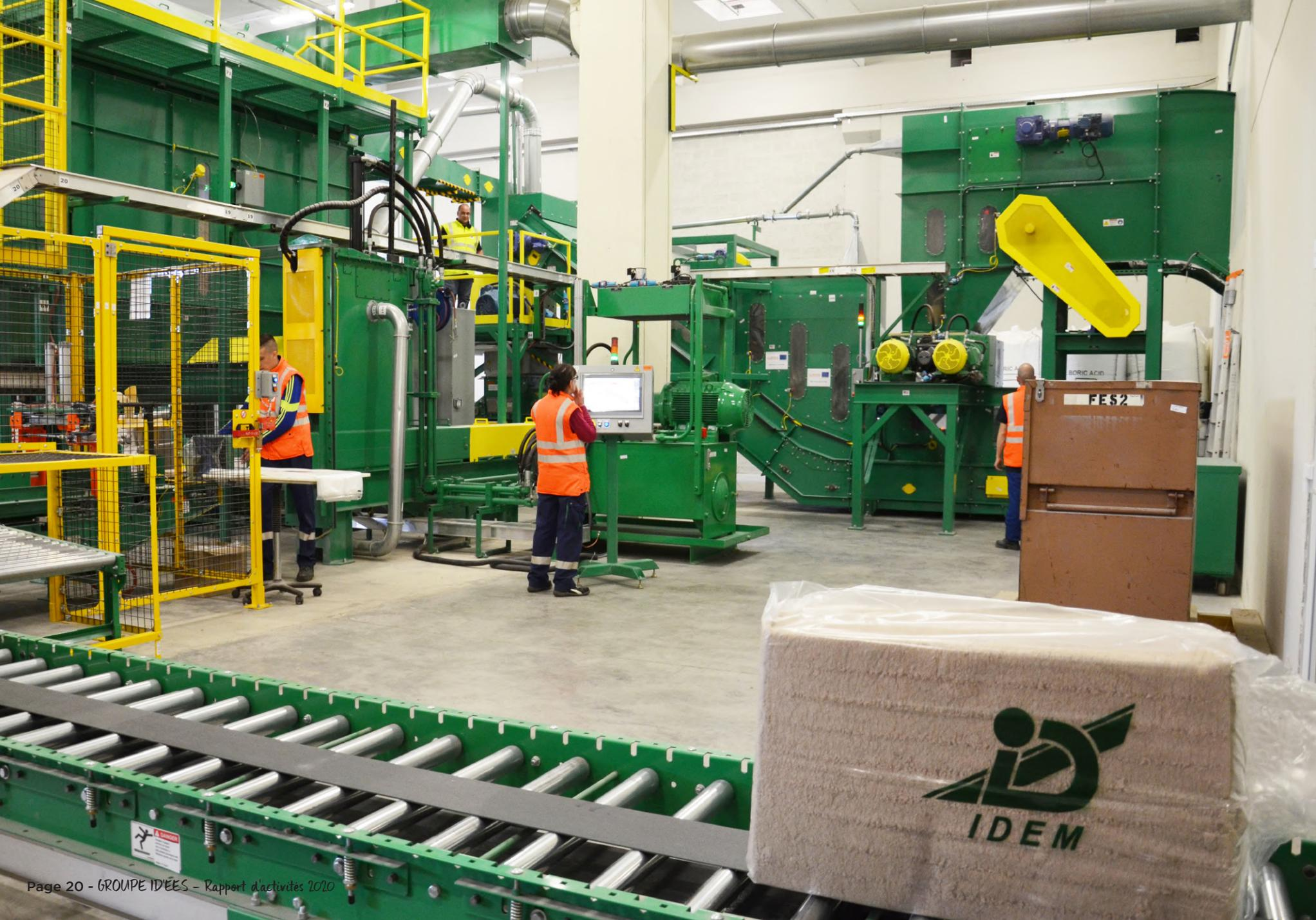
ID'EES SERVICES est une entreprise d'insertion industrielle qui conjugue circuits courts, valorisation des déchets et inclusion. L'activité principale d>ID'EES SERVICES est la fabrication de produits de conditionnement et de protection en carton ondulé à partir de rebuts de fabrication (non-conformités) de l'industrie cartonnaire, complétée par la production de l'isolant thermique biosourcé NOVIDEM.
