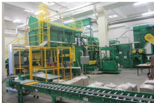
Cette machine broie le carton, puis le défibre pour en faire de la ouate. © Radio France - Marion Bastit
