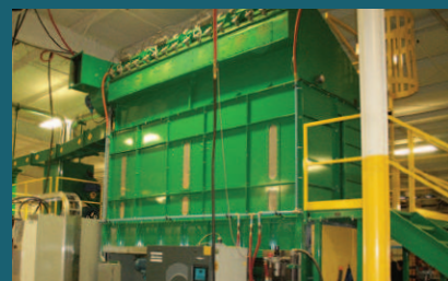
L'unité de production où la ouate est traitée avec les additifs anti-feu, anti-humidité...
