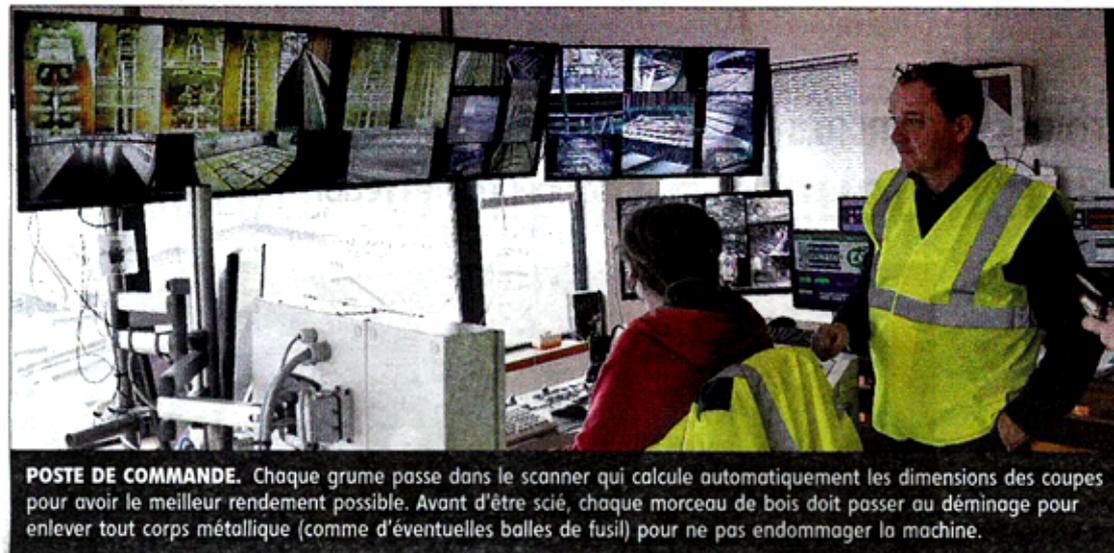
**POSTE DE COMMANDE.** Chaque grume passe dans le scanner qui calcule automatiquement les dimensions des coupes pour avoir le meilleur rendement possible. Avant d'être scié, chaque morceau de bois doit passer au déminage pour enlever tout corps métallique (comme d'éventuelles balles de fusil) pour ne pas endommager la machine.
